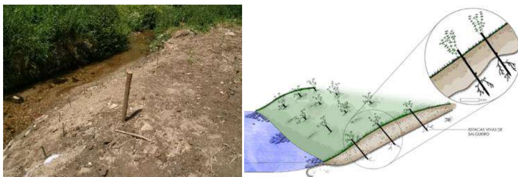
Figura 30 - Estacaria viva (secção transversal e alçado)
