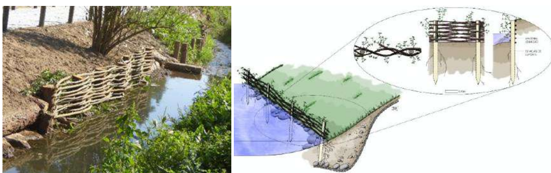
Figura 25 - Entrançado vivo (fotografia, secção transversal e alçado)
