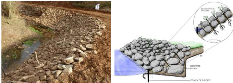
Figura 27 – Enrocamento vivo (fotografia, secção transversal e alçado)
